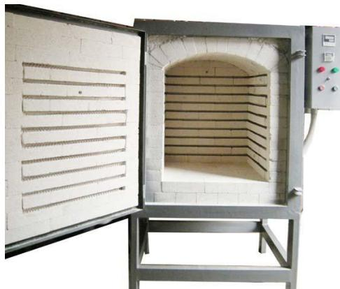
**Figura 5.- Material refractario colocado como revestimiento de un horno**
