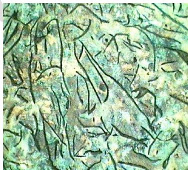
Foto 1.- Micrografía de una fundición gris con escamas de grafito embebidas en una matriz de ferrita- \alpha
