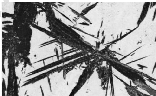
Foto N° 5.- Microestructura de la Bainita en un acero 4360, observada con microscopio
