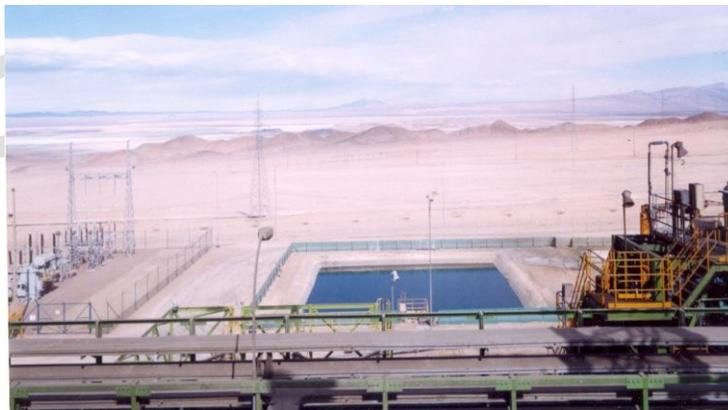
Foto 2.- Vista de una Pileta de Extracción por Solventes (SX)
