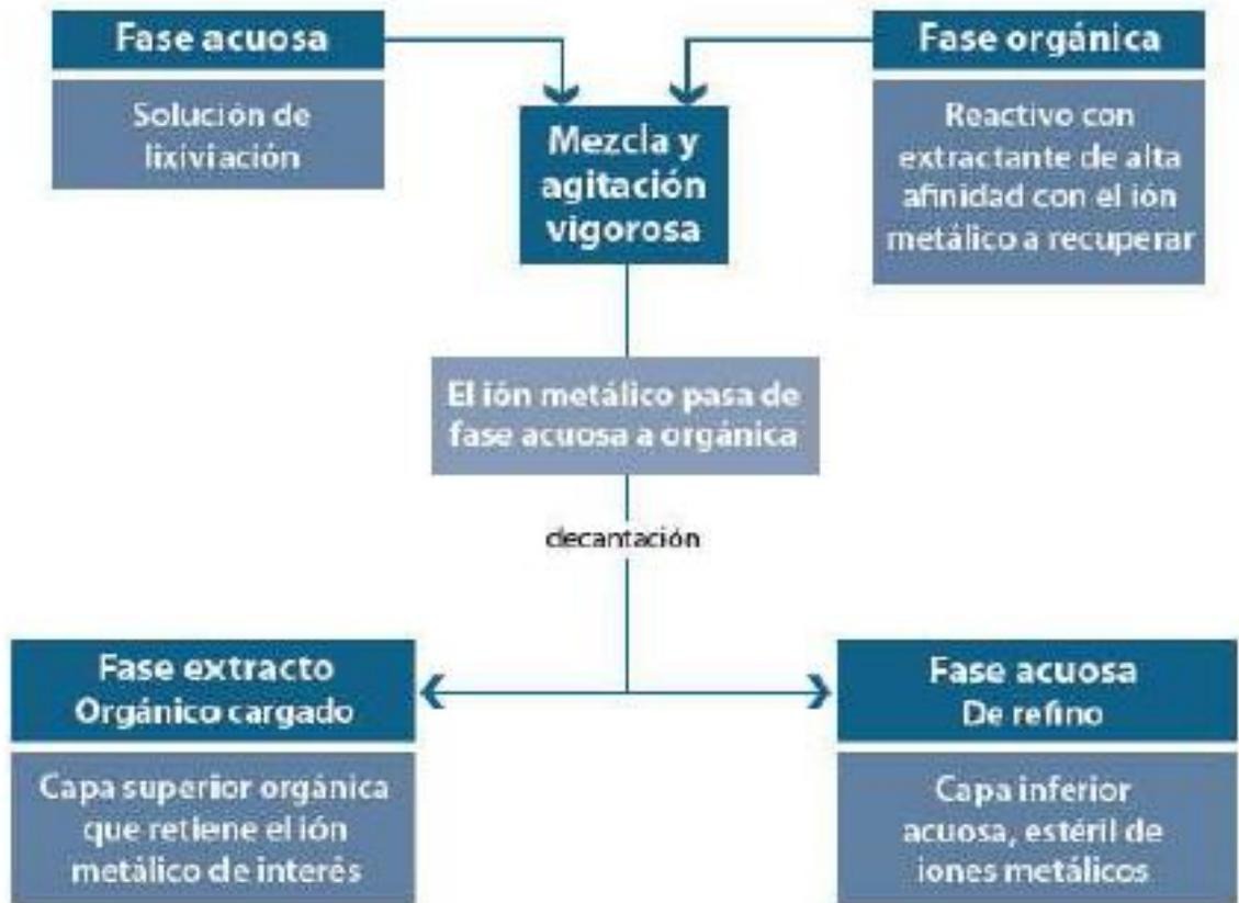
Esquema 2.- Fases y reacciones químicas en la Pileta de Extracción por Solventes (SX)
