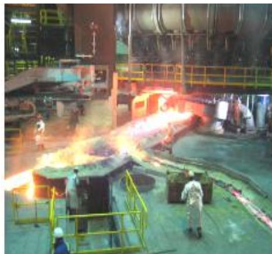
**Foto N° 7.- Sangrado del Arrabio en el AH**
