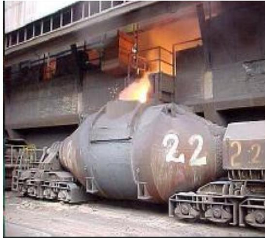
**Foto N° 2.- Carro torpedo portador del Arrabio**
