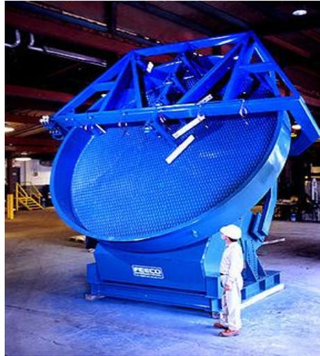
**Foto N° 2.- Platos de Peletización en Planta de Producción**
