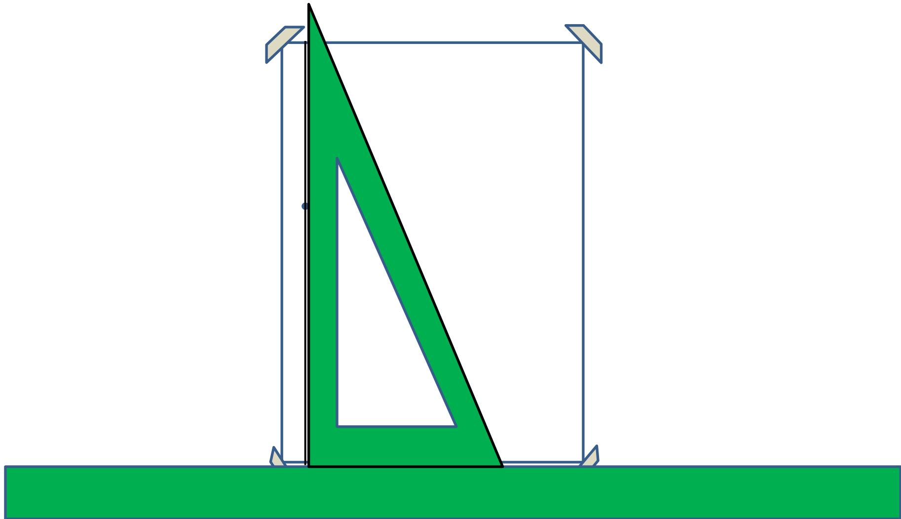
Con la regla milimetrada mido 10 mm en el borde derecho del formato y marcar un punto, siempre usando el lápiz H
