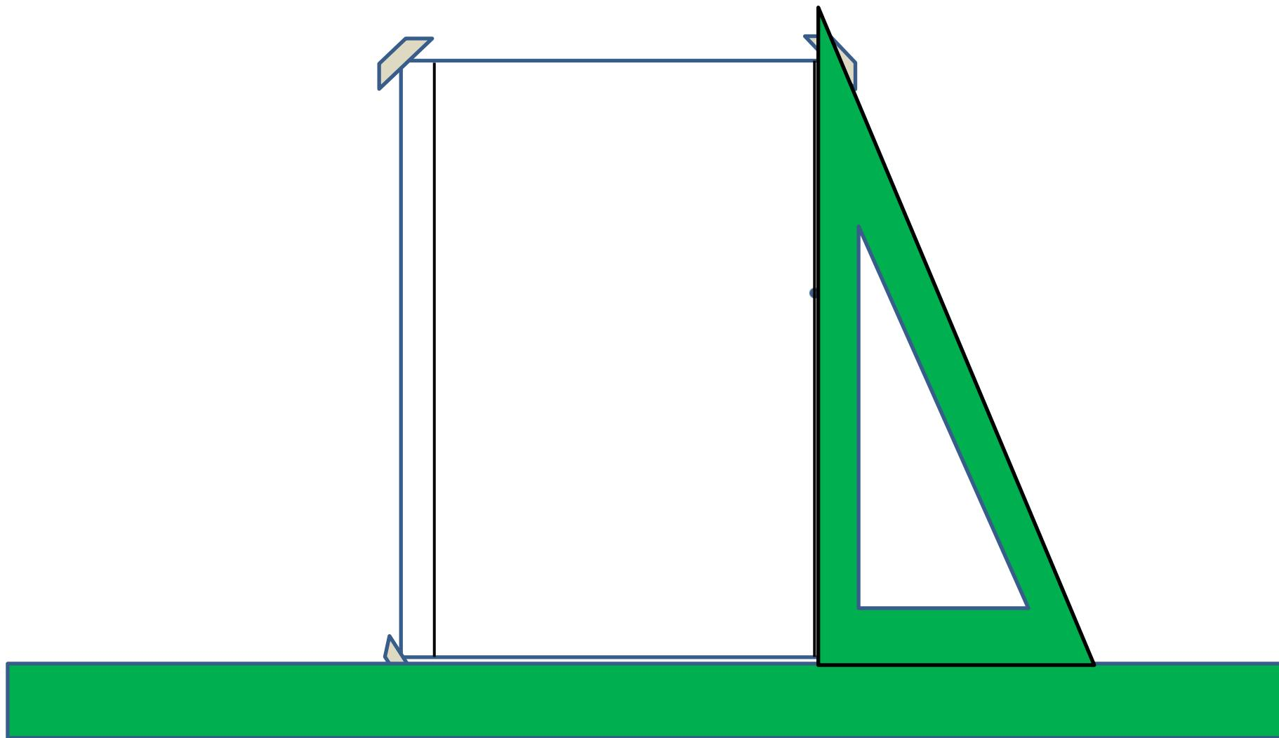
Para el margen superior medir desde el borde superior del formato, 10mm hacia abajo y marcar un punto ( lápiz H)
