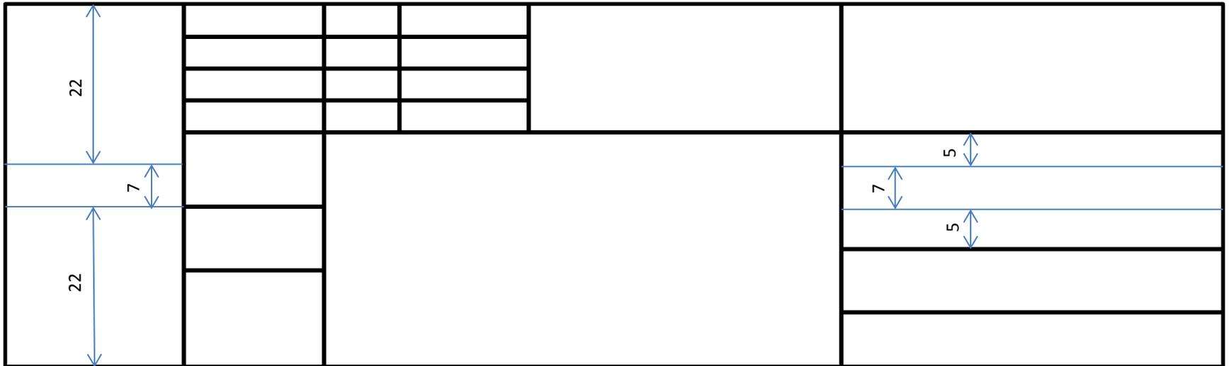
Finalmente trazamos los renglones con altura de letra mayúscula  $h = 3\text{mm}$ , y dibujamos el símbolo correspondiente. Ampliando la zona de aplicación:
