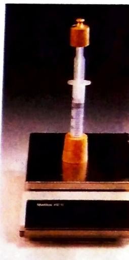
La balanza marca la misma masa en ambos casos. Sin embargo, el volumen del aire de la jeringa de la derecha es menor, debido a que está comprimido por la pesa sobre el émbolo.
