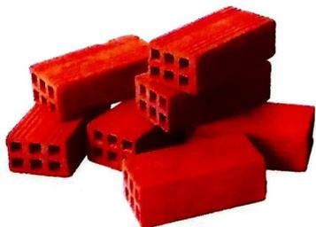
El aire es un muy buen aislante térmico. Los ladrillos huecos se valen de esta propiedad para mantener la temperatura del interior de la casa.
